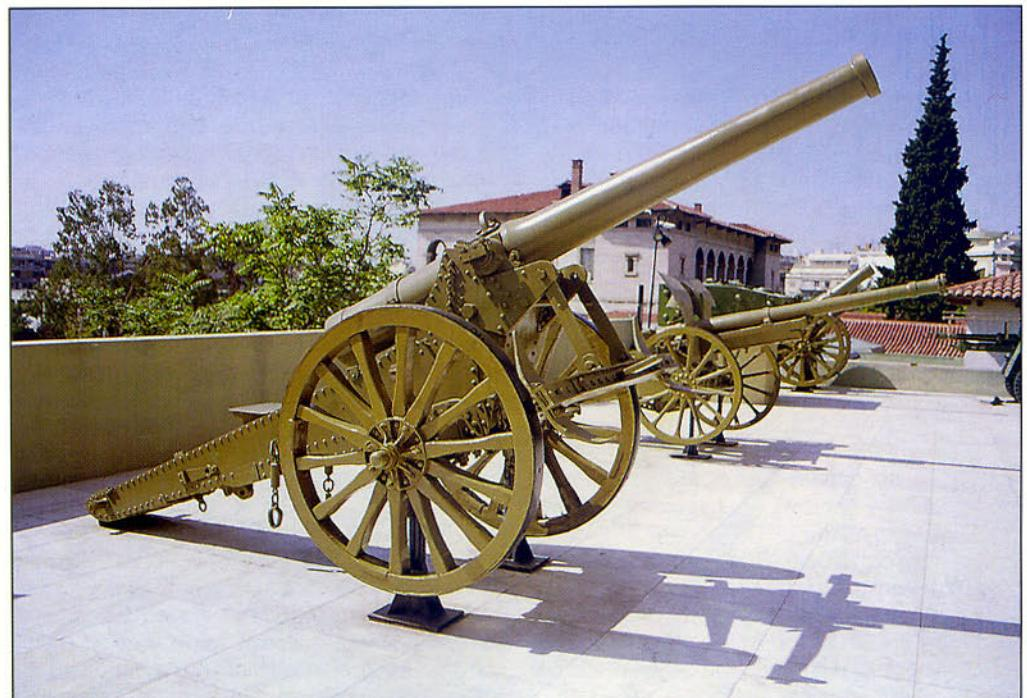
Βαρύ πυροβόλο De Bange των 120 mm, γαλλικής κατασκευής. Είναι εμφανής η απουσία συστήματος οπισθοδρόμησης (φωτ. Ι.Σ. Θεοδωράτος).
