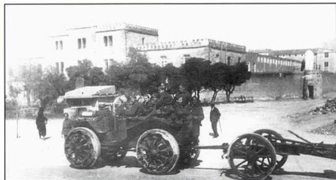
Ελκυστήρες πυροβολικού Fiat/Pavesi P4/110 4x4, με συμπαγούς κατασκευής τροχούς.
